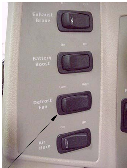
Defrost Fan Switch
